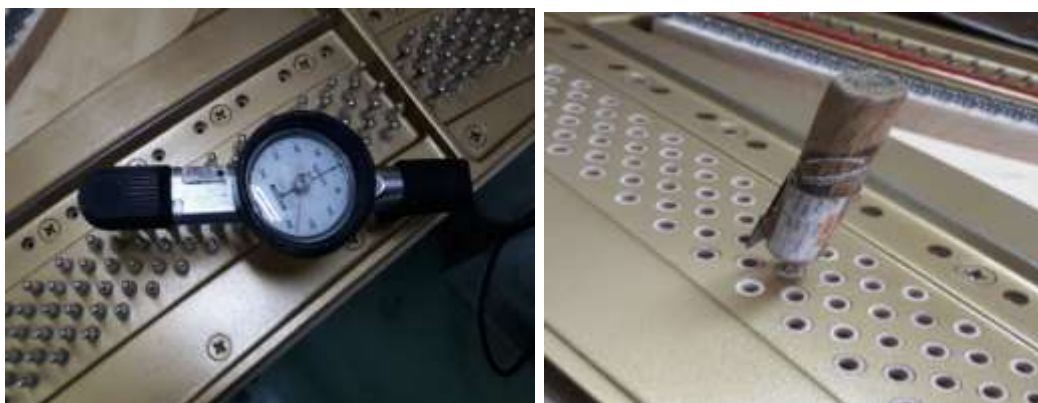
Gambar 4.5 Pengecekan torque dan kedalaman pengeboran dengan JIG
