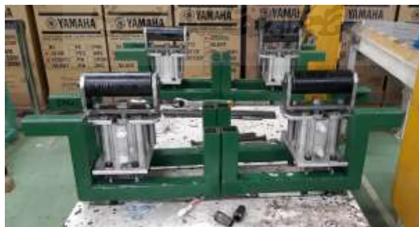
Gambar 4.12 Hasil pabrikasi alat bantu angkat kabinet strung back
