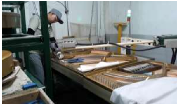
Gambar 3.7 Pemasangan wire middle
