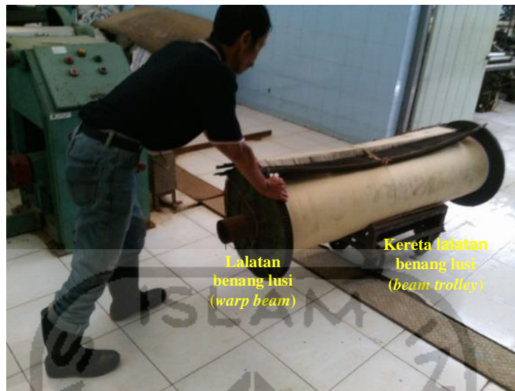
Gambar 3.2 Proses pemindahan lalatan benang lusi
