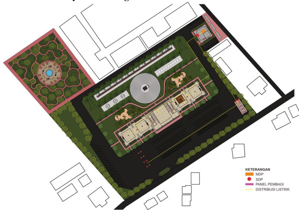
Gambar 4.18 Rancangan Sistem Penyediaan Energi. Sumber: Penulis
