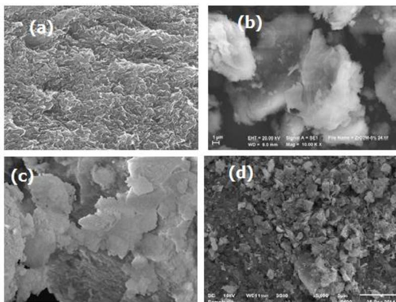
Fig. 6. Surface morphology of (a) MMT (b) Zr/MMT (c) SZr/MMT (d) Ni-SZr/MMT.
