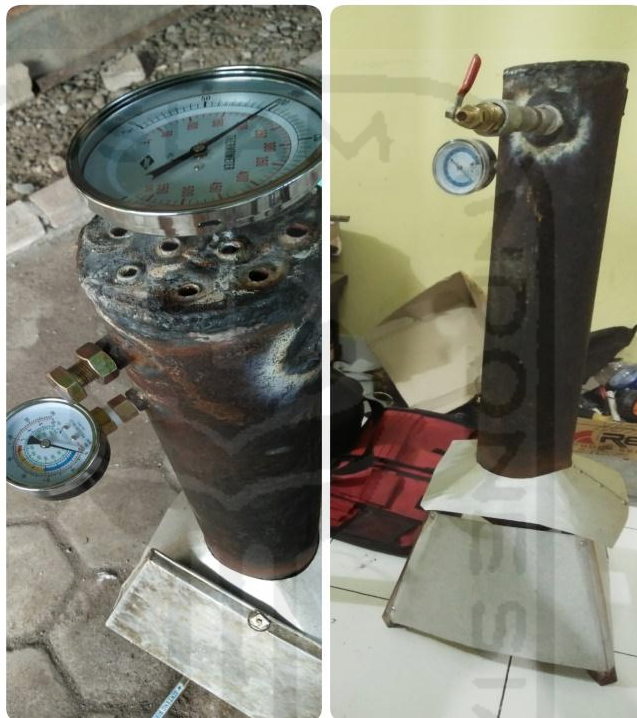
Gambar 4.2 Hasil Akhir dari Boiler
