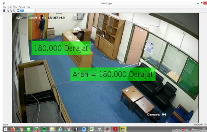
Gambar 3. 15 Visualisasi deteksi arah menggunakan Optical Flow
