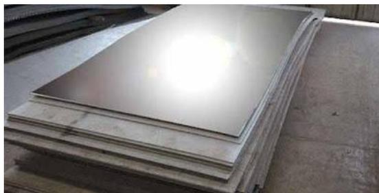
Gambar 3.11 Plat Besi dengan tebal 0.2 mm
