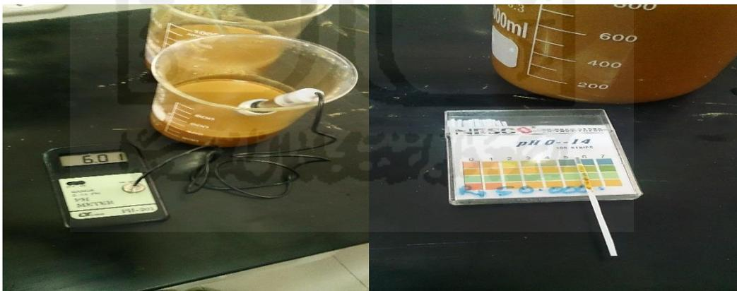
**Gambar 4.8** Pengujian pH Adsorbent Saat Diasamkan
