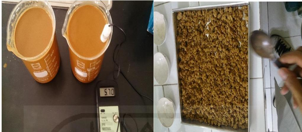
**Gambar 4.10** Nilai pH Dari Adsorbent Non Aktivasi dan Adsorben Yang Telah Di Oven
