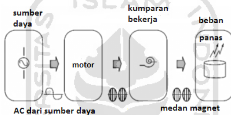
Gambar 2.3. Blok diagram kompor pemanas induksi. [10]
