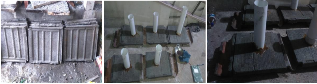
Gambar 5 Pengujian Rembesan Air. Pengujian rembesan air terhadap genteng beton dilakukan selama 1x24 jam dengan menggunakan pipa pvc, malam (lilin), dan air. Uji ini untuk mengetahui seberapa besar rembesan air yg terjadi pada genteng beton.
