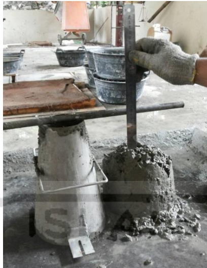
Gambar L.49.4. Proses mencari nilai slump pada beton normal (mutu tinggi)
