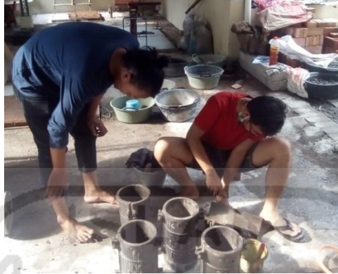
Gambar L.49.1. Pembersihan cetakan silinder
