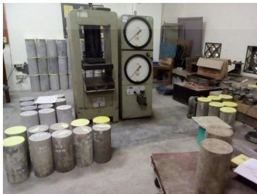
Gambar L.49.9. Persiapan untuk pengujian kuat tarik/belah silinder beton
