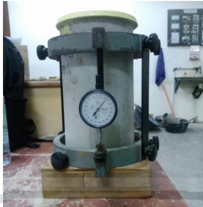
Gambar L.49.7. Sampel silinder beton setelah memsangkan alat untuk pengujian kuat tekan dan analisis modulus elastisitas
