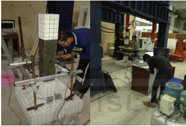
25. Setup pengujian kolom GFRP
