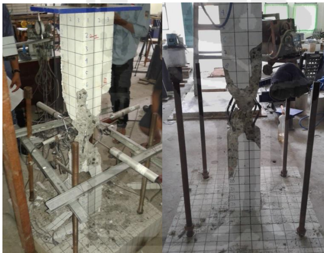
26. Pola kerusakan kolom standar (KS)
