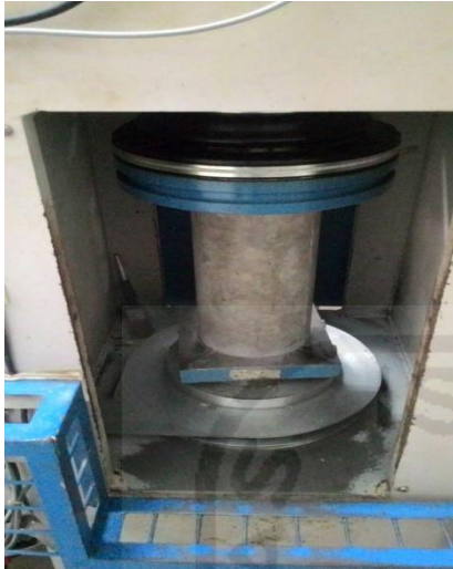
7. Uji desak beton silinder
