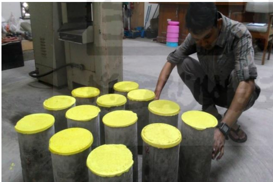
6. Sampel silinder umur 7 hari
