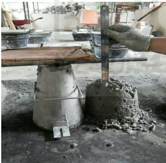
3. Pengukuran tinggi slump silinder
