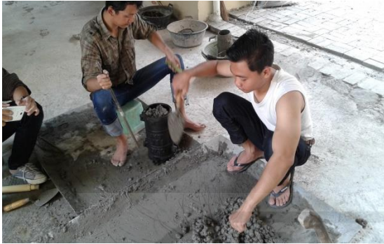
4. Pembuatan sampel silinder
