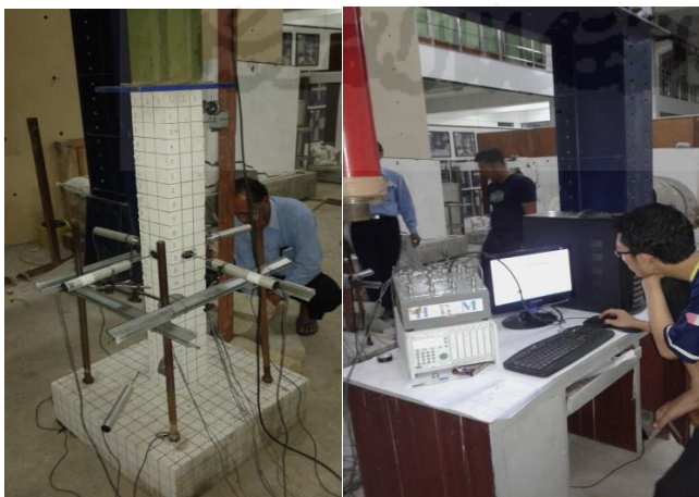
24. Setup pengujian kolom standar
