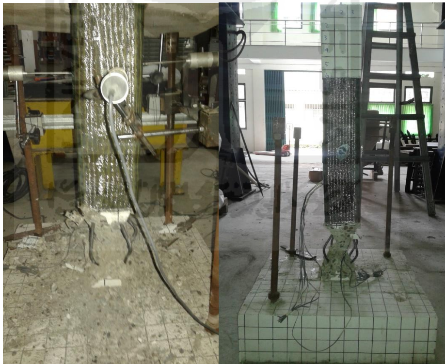
Gambar 5.18 Kerusakan Kolom Glass 2 (KG2)
