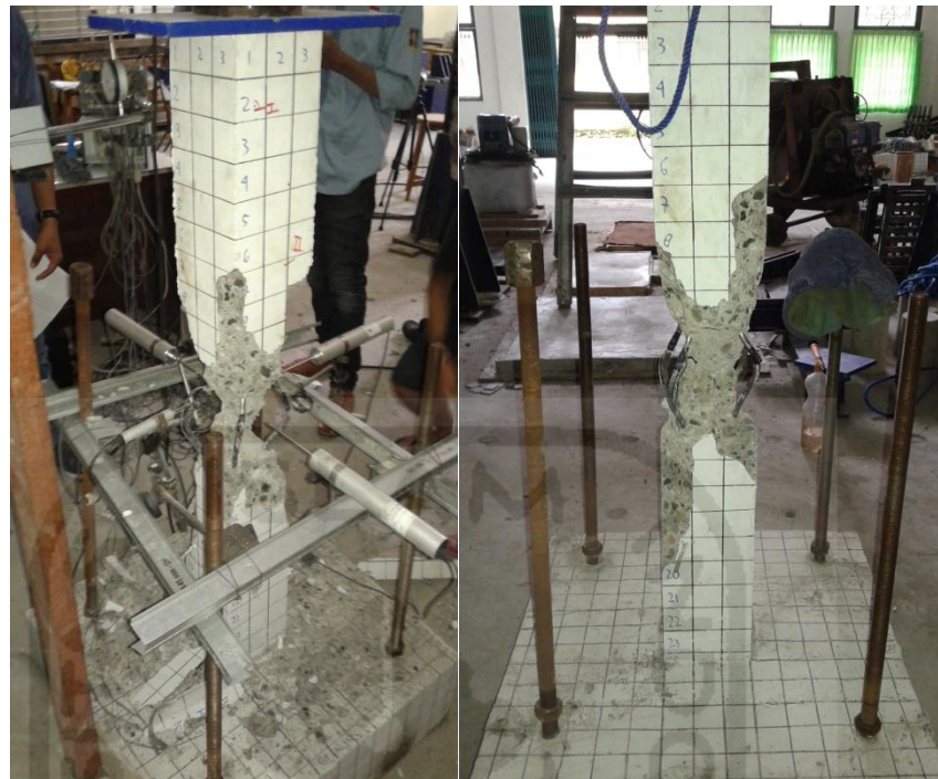
Gambar 5.15 Kerusakan Kolom Standar (KS)
