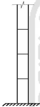
Gambar 3.6 Kolom dengan dimensi seragam
