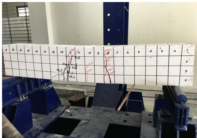
7.Pola Keretakan BP-1 Tanpa Perkuatan (B)
