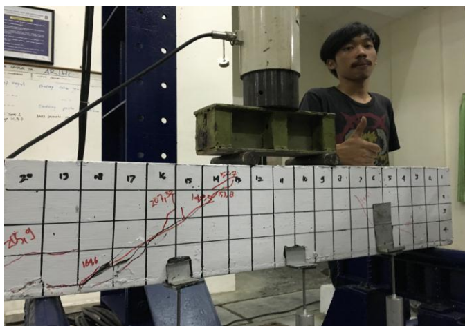
14. Pola Keretakan BP-2 Dengan Perkuatan (A)
