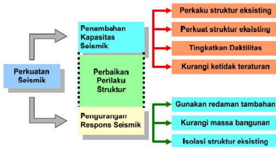
Gambar 3.30 Strategi sistem perkuatan untuk sistem penahan beban lateral (Murty et al , 2009)
