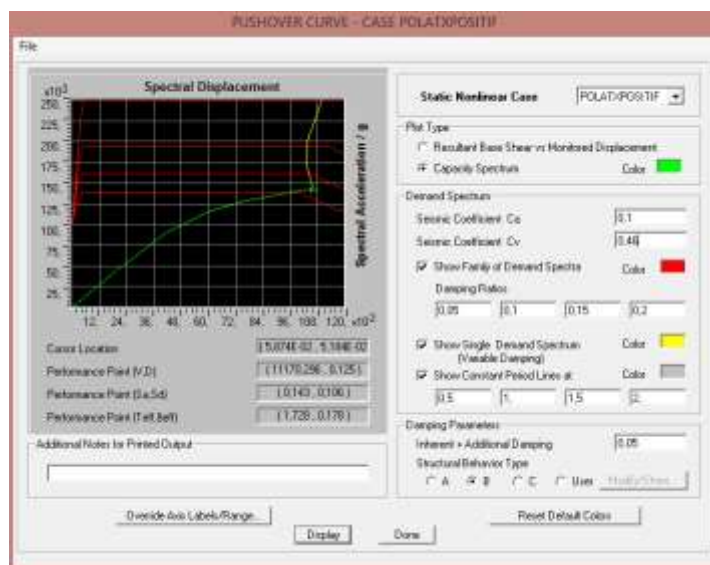
Gambar 5.62 Spektrum kapasitas pushover pemodelan KJ-P5 arah X utara ke selatan
