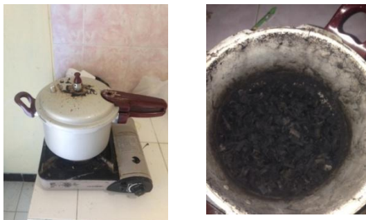
Gambar 5.2. Alat presto untuk karbonisasi hidrotermal (kiri) dan arang hasil proses karbonisasi hidrotermal (kanan)
