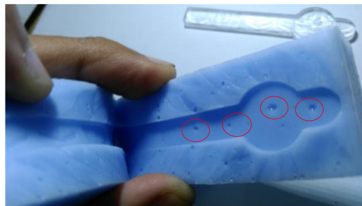
Gambar 28. Adanya Gelembung Udara yang Terjebak.
