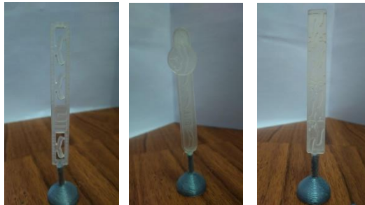
Gambar 25. Pemasangan Master dengan Sprue dan Area Nozel.
