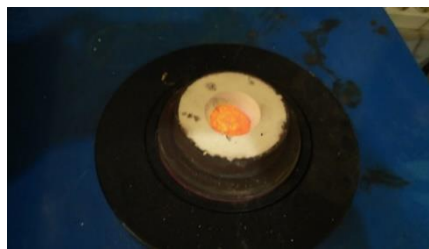
Gambar 35. Hasil Penuangan Logam Cair.
