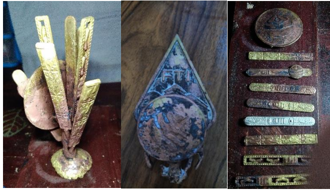
Gambar 36. Hasil Penuangan Logam yang sudah dibersihkan dari gipsum dan dipotong.
