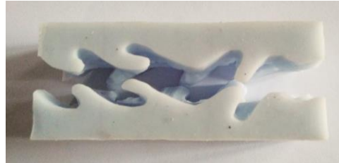
Gambar 30. Pola lokator pembelahan cetakan silikon.
