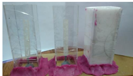
Gambar 26. Wadah Akrilik Bagian Bawah Dilapis Menggunakan Lilin Mainan.
