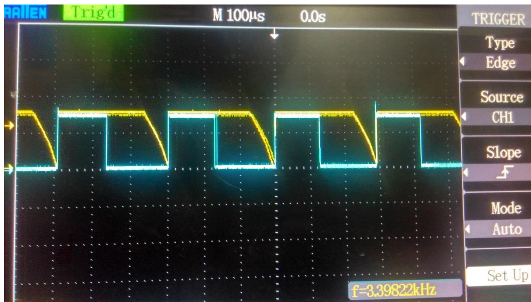
Gambar 4.7 Gelombang tegangan keluaran Mekanik Bootstrap sebelumnya pada frekuensi 3,3kHz [1]
