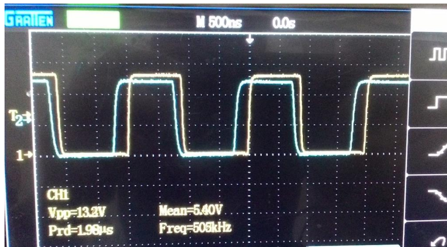
Gambar 4.6 Gelombang tegangan keluaran modifikasi Mekanik Bootstrap pada frekuensi 500kHz.
