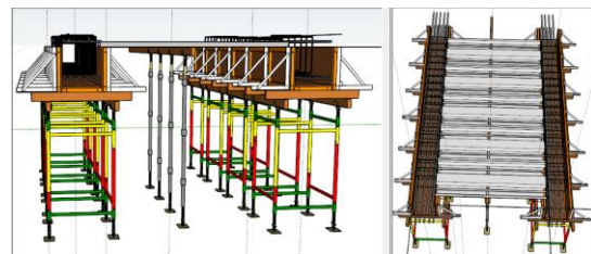
Gambar 3 Penampang Pipe Support Sebagai Perancah
