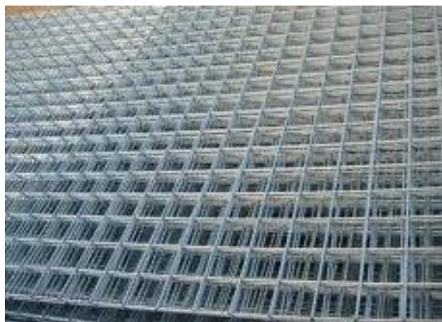
Gambar 3.7 Gambar Penampang Wiremesh Lembaran ( Sumber : http://www.sarana-bangunan.com , 2017)
