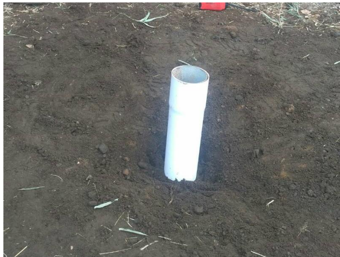
Gambar 5.9 Pipa Pralon dalam Lubang Auger
