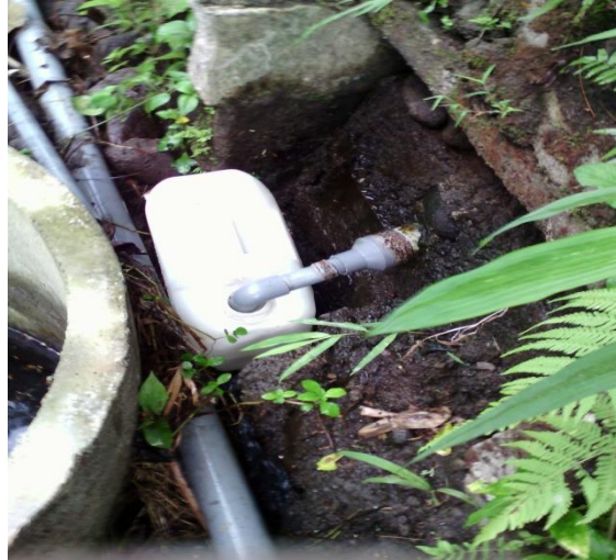
Gambar 7.1 Pengukuran Debit Eksisting
