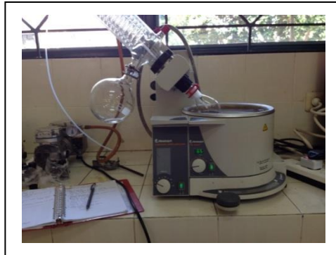
Gambar 3.18. Pemekatan Sampel Airtanah Oleh Rotary Evaporator
