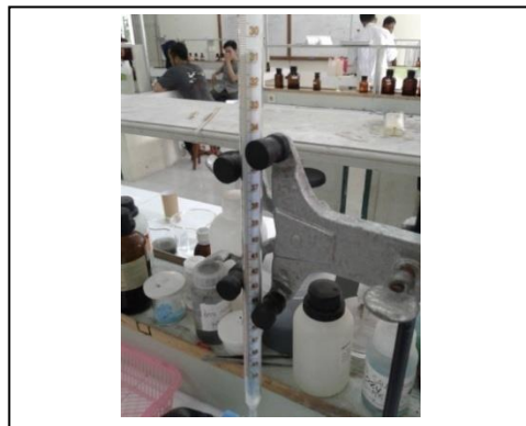
Gambar 3.16. Pemurnian ( Clean Up ) Sampel Airtanah
