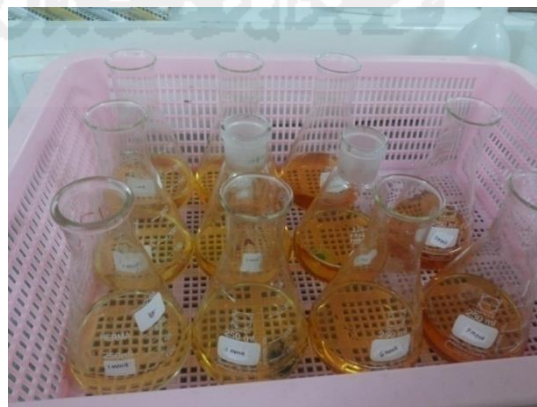
Gambar 3.6 Larutan KI yang siap diabsorbansi menggunakan Spektrofotometri
