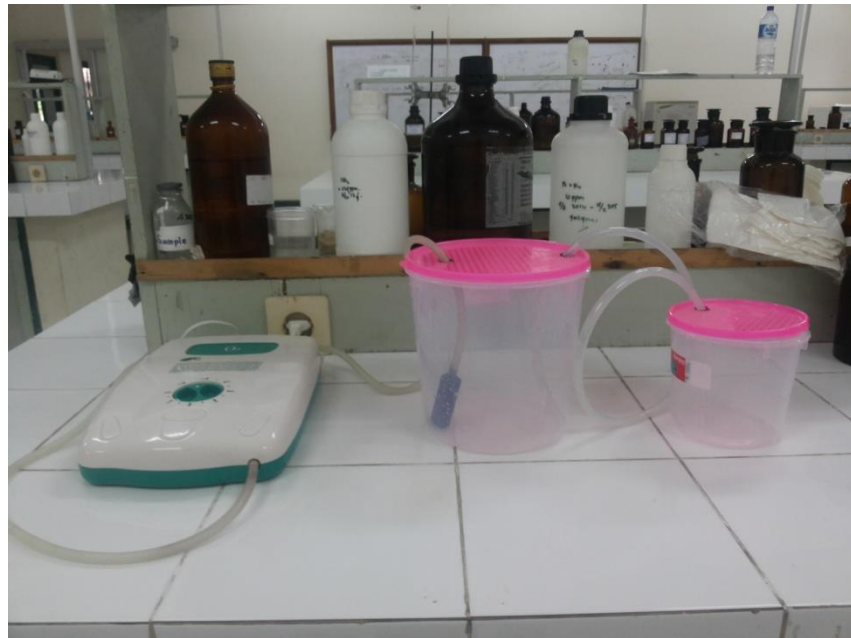
Gambar 3.2 Rangkaian reaktor batch untuk pengujian air limbah
