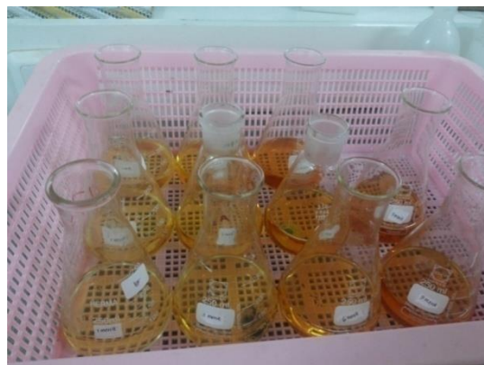
Gambar 3.6 Larutan KI yang siap diabsorbansi menggunakan Spektrofotometri
