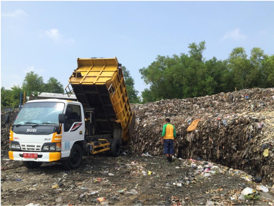
Gambar Lampiran 1. Truk sampah yang masuk ke TPA Banyuroto setelah dilakukan penimbangan dan pencatatan nomer polisi kendaraan, nama sopir dan volume sampah oleh petugas kemudian dibuang ke zona landfill yang sudah diarahkan oleh petugas TPA Banyuroto
