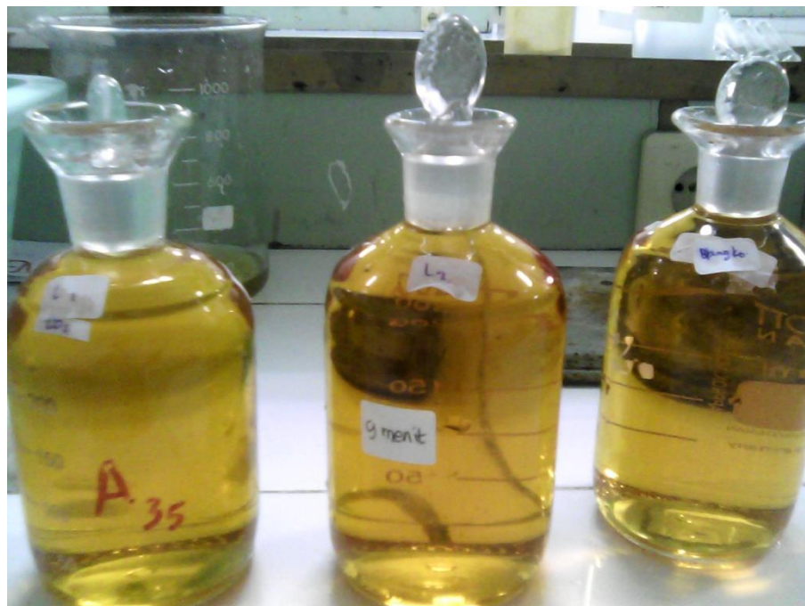
Gambar 10 Uji BOD setelah penambahan MnSO_4 , KOH-KI, dan H_2SO_4
