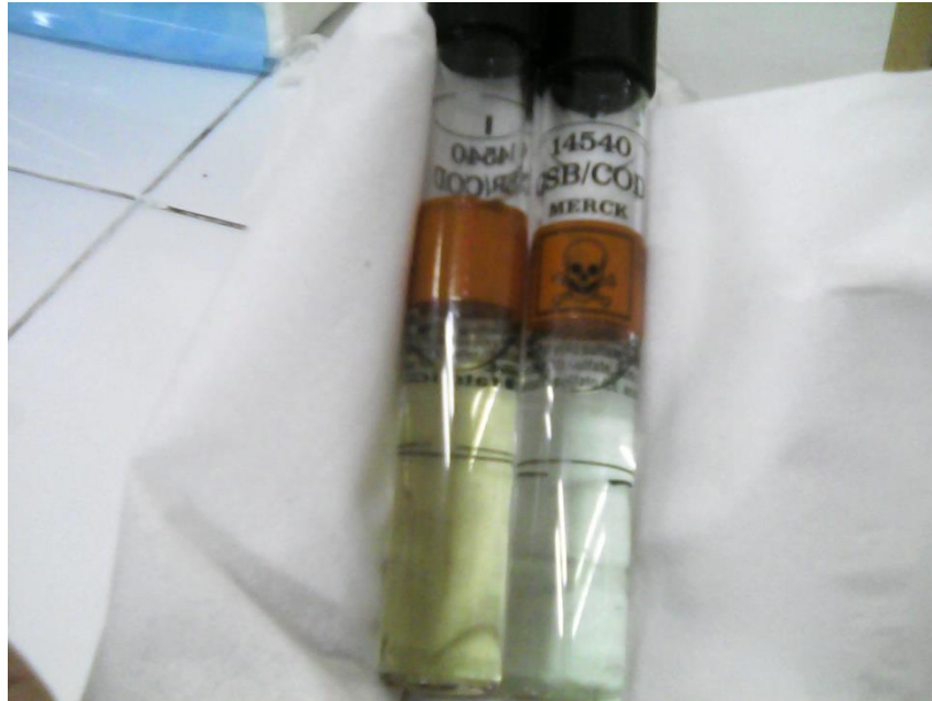
Gambar 7 Uji coba COD menggunakan digestion solution tinggi (kiri) dan rendah (kanan)
