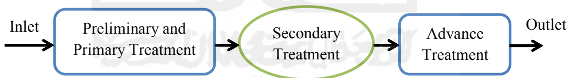
Gambar 3.4 Tahapan proses pengolahan air limbah
