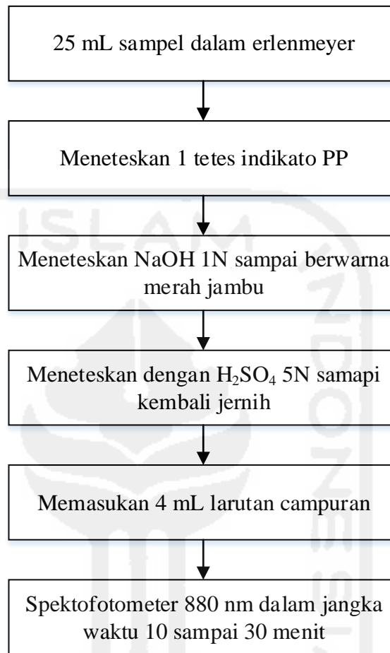
Gambar Diagram alir pengujian fosfat (PO 4 )
