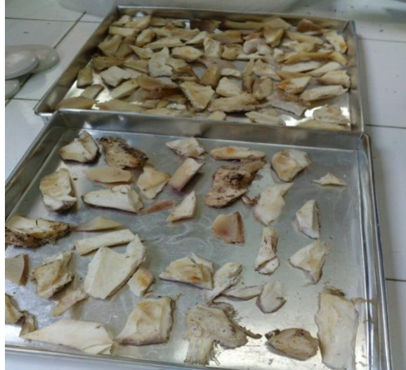
Gambar 3.4. Hasil pengeringan tulang menggunakan oven selama 60 menit
