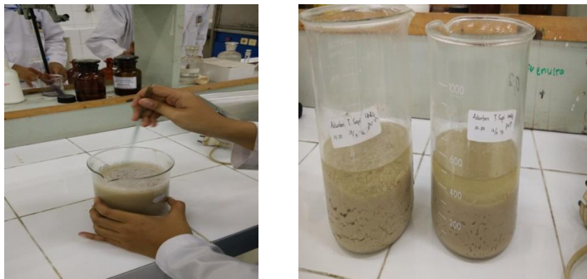
Gambar 3.7. Proses aktivasi adsorben tulang sapi menggunakan \text{HNO}_3 1 M
