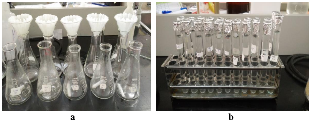
Gambar 3.10. a. Penyaringan menggunakan kertas saring b. Sampel pengujian untuk analisis SSA
