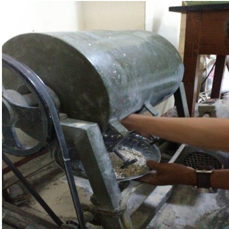
Gambar 3.5. a. Penggerusan tulang menggunakan Rod Mill
