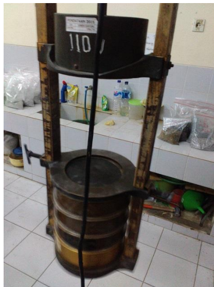
Gambar 3.5 Pengayakan Tulang Sapi untuk Mendapatkan Ukuran 100 Mesh
