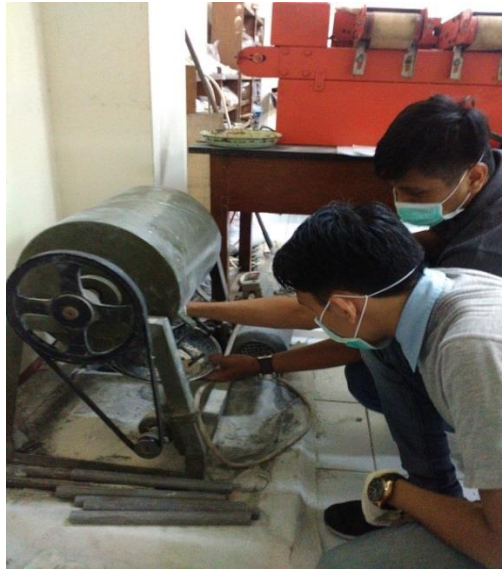
Gambar 3.4 Proses Penghalusan Tulang Sapi Menjadi Bentuk Serbuk
