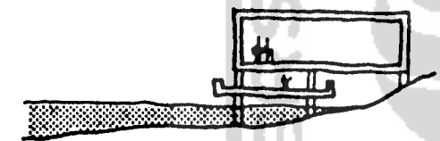
Menjorokkan bangunan ke dalam air.
