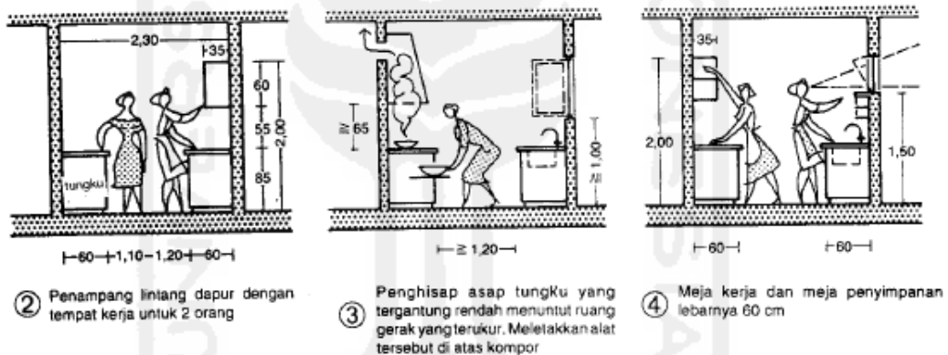
Gambar 2.28. Area yang dibutuhkan bagi operasional kegiatan di dapur Sumber : Data Arsitek Jilid 2
