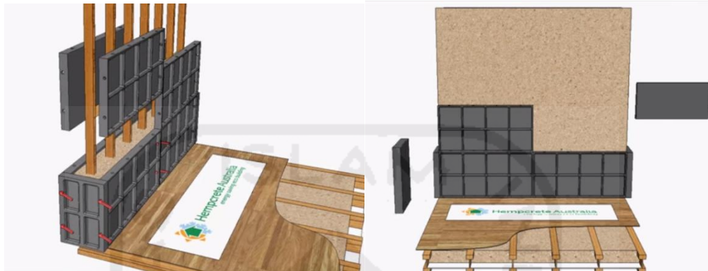
Gambar 2.32 Proses pencetakan Hempcrete
