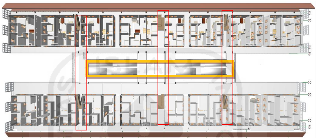
Gambar 4.8 Rancangan system akses diffable dan keselamatan bangunan
