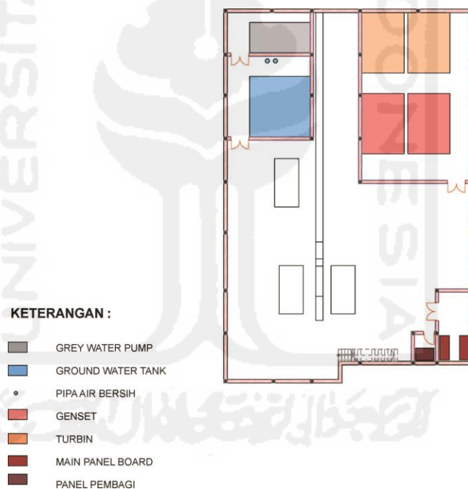
Gambar 4-23 Skematik Utilitas Basement
