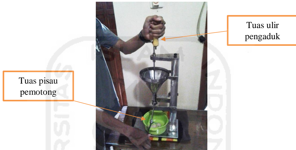
Gambar 3-8 Cara uji coba alat tanpa menggunakan motor.
