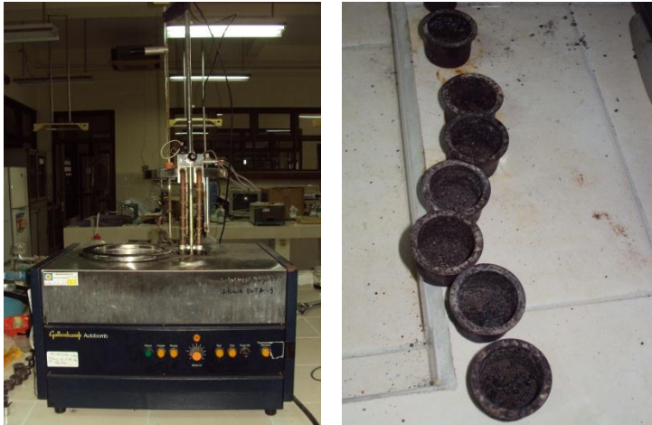
Gambar 2. Proses dan alat bom kalori untuk menghitung nilai kalor
