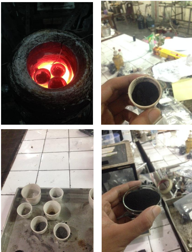
Gambar 1. Proses pemanasan briket dengan menggunakan furnis
