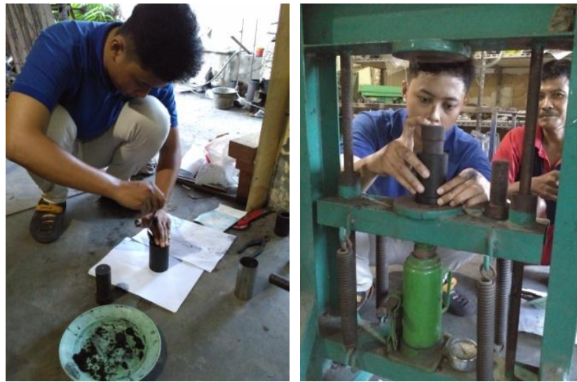
Gambar 3.8. Proses pencetakan dan pengempaan briket
