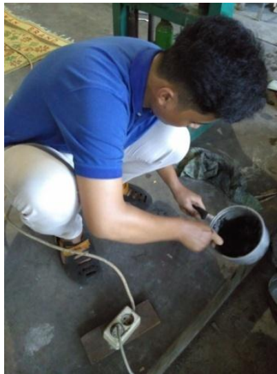
Gambar 3.7 Proses pencampuran bahan baku dan perekat tapioca
