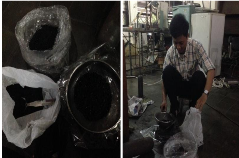
Gambar 3.5. Proses penghalusan dan pengayakan tempurung kelapa
