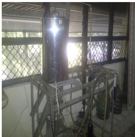
Alat Pirolisis ini untuk membuat bahan baku menjadi arang untuk diolah menjadi briket, bahan baku sampah kebun dan kulit kacang dipilah dahulu sebelum dimasukkan ke alat pirolisis melalui proses dekomposisi kimia tanpa sedikit oksigen atau reagen lainnya. Kapasitas alat ini sekitar 2 kg, dan berbahan dari besi (stainless steel) anti karat.
