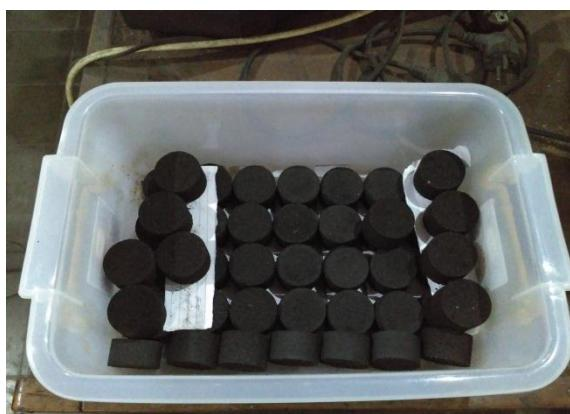
Briket dari bahan baku sampah kebun campuran dan kulit kacang tanah dengan tambahan minyak jelantah pada komposisi 80% : 20% menggunakan perekat tepung tapioka dengan tekanan 25 Mpa, hasilnya seperti pada gambar disamping.
