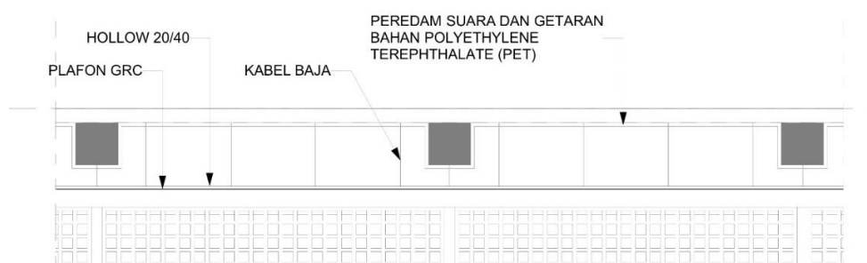
Gambar 6.3 Detail Plafon dan Peredam Suara Pada Langit-Langit
