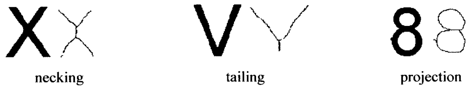
Gambar 11 : Artifak-artifak yang terjadi pada saat proses thinning
