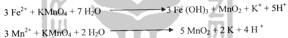
Karena adanya lapisan  $\text{KMnO}_4$  pada permukaan pasir yang nantinya berfungsi sebagai oksidator maka pasir ini dinamakan pasir aktif. Unsur Fe dan Mn yang telah berubah menjadi bentuk tersuspensi akan diserap oleh lapisan pasir kuarsa yang juga berfungsi sebagai penyaring (filter), sehingga air hasil olahan selain kandungan Fe dan Mn-nya turun juga akan terlihat jernih.
