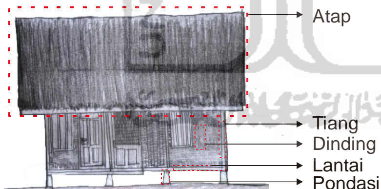
Gambar 3.19 Identifikasi Material dan Elemen Rumah Adat Kampung Naga
