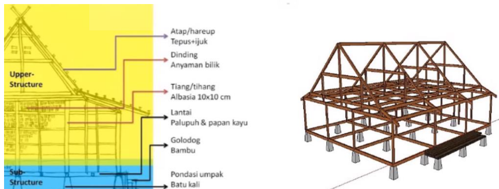
Gambar 2. 17 Sistem Struktur Rumah Adat Kampung Naga
