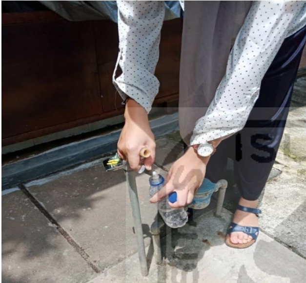
1. Proses pengambilan sampel air uji sisa klorin
