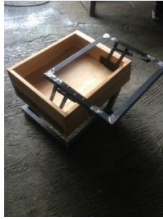
Gambar 4-59 Percobaan pemasangan mekanisme di rak utama meja
