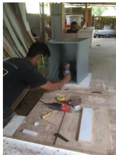
Gambar 4-49 Proses pembuatan jalur rel menggunakan mesin router
