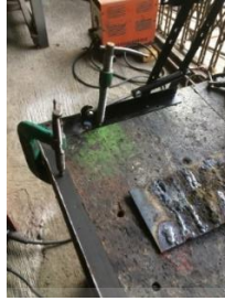
Gambar 4-57 Penyambungan part tambahan dengan part lift up top mechanism
