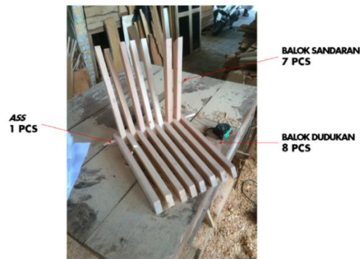
Gambar 4-53 Perakitan dan penyambungan bagian-bagian dudukan dan sandaran kursi
