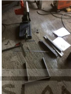
Gambar 4-39 Proses pemotongan besi hollow 35 x 15 mm
