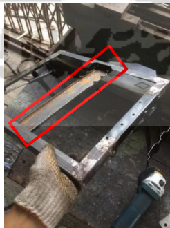
Gambar 4-60 Penggabungan 4 level kemiringan meja ke lift up top mechanism
