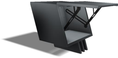
Gambar 4-23 Mekanisme extend pada rak meja
