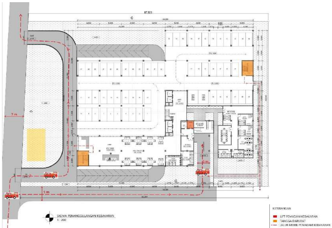
Gambar 5.20. Skema Keselamatan Kebakaran
