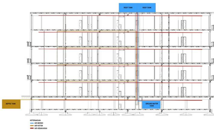
Untuk Air bersih mengambil dari PDAM lalu di alirkan menuju Ground Water Tank. Kemudian dialirkan melalui shaft utama ke roof tank. Kemudian di alirkan ke tiap-tiap hunian dengan shaft kecil.
