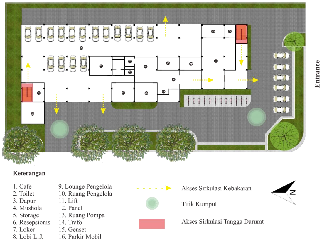
Gambar 5.17 Rancangan Keselamatan Bangunan
